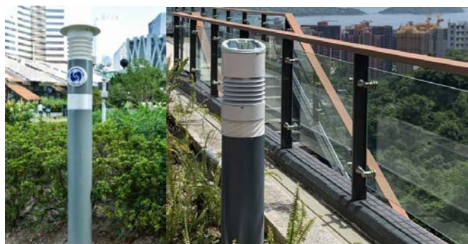
裝置於零碳天地(左)及香港中文大學(右)的路燈型自動氣象站進行天氣測量試驗
