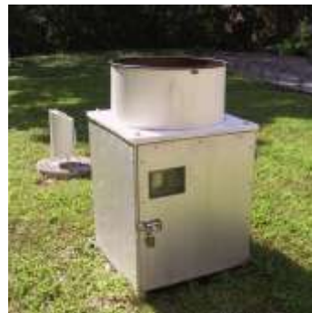
查迪型降雨率測量器
