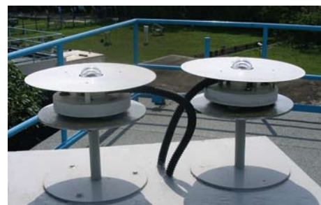
圖2. 安裝在京士柏氣象站的太陽輻射測量儀器
